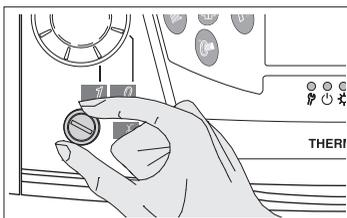
En cas d'anomalies d'allumage ou de fonctionnement, la chaudière effectuera un "ARRET DE BLOCCAGE" signalé par le "bouton/voiant" rouge placé sur le brûleur et par la signalisation rouge du panneau de commande.
