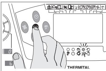
Il gruppo termico effettuerà la fase di avviamento e resterà in funzione in modalità "climatica", secondo i parametri preimpostati, fino a quando saranno state raggiunte le temperature regolate.
